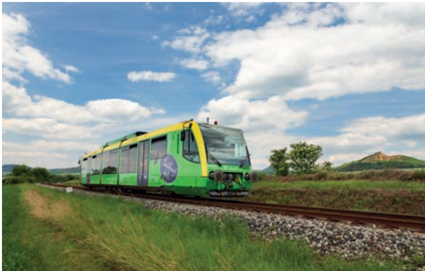
RegioSprinter-Niederflurgerät, das die Betrieb der Pflaumenbahn.
